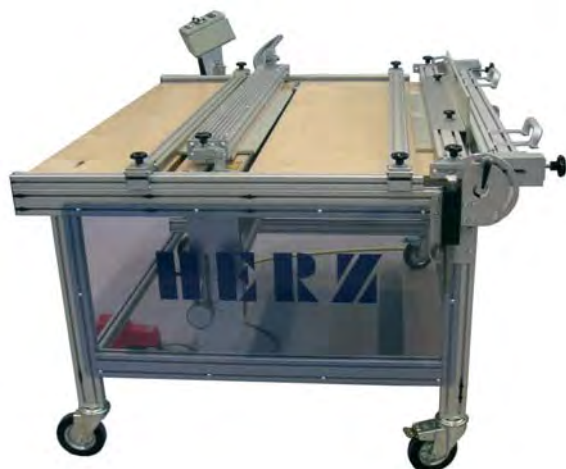
Рис.: Мобильный нагревательный стол, включая дополнительное оснащение
